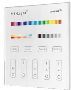
Tento ovladač umožnuje nastavit barvy různých odstínů smícháním barev RGB, W a WW. Je ho vhodné použít s LED páskem RGB+W+WW (18287 - FLB6-RGB+W+WW-24VDC). Lze nastavovat změnu náhradní teploty chromatičnosti od 3000K do 6000K a současně s tím i RGB barvy. Jedním ovladačem je možné řídit více přijímačů a ty ještě rozdělit až na čtyři nezávisle ovládané skupiny.
