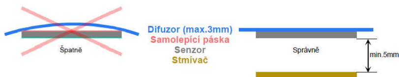
Obr.2 - Instalace senzoru.
